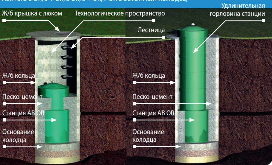
РИСУНОК 4. ПРИМЕР РЕАЛИЗАЦИИ МОНТАЖА СТАНЦИЙ ALTA BIO 3 OR, 3 + OR, 5 OR, 5 + OR, 7 OR В БЕТОННЫЙ КОЛОДЕЦ
